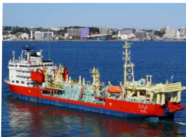
▲海翔丸(浚渫兼油回収船)
